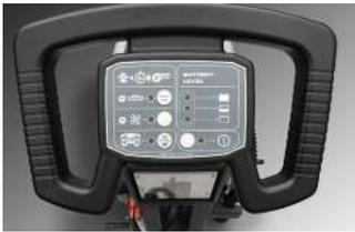
Interruttore on/off che previene accensioni accidentali. Protezione contro sovraccarichi, eccessiva scarica della batteria (solo DC) e utilizzo accidentale. Impostazione Eco Energy per utilizzo prolungato e funzionamento estremamente silenzioso (solo modelli a batteria).
